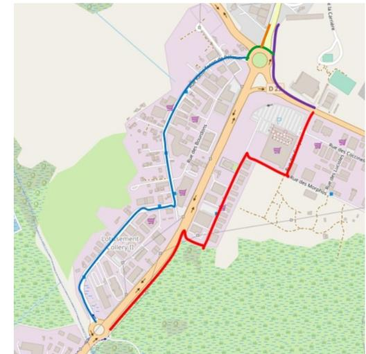
Figure 11 – Principe de raccordement des voies cycles pour le projet
