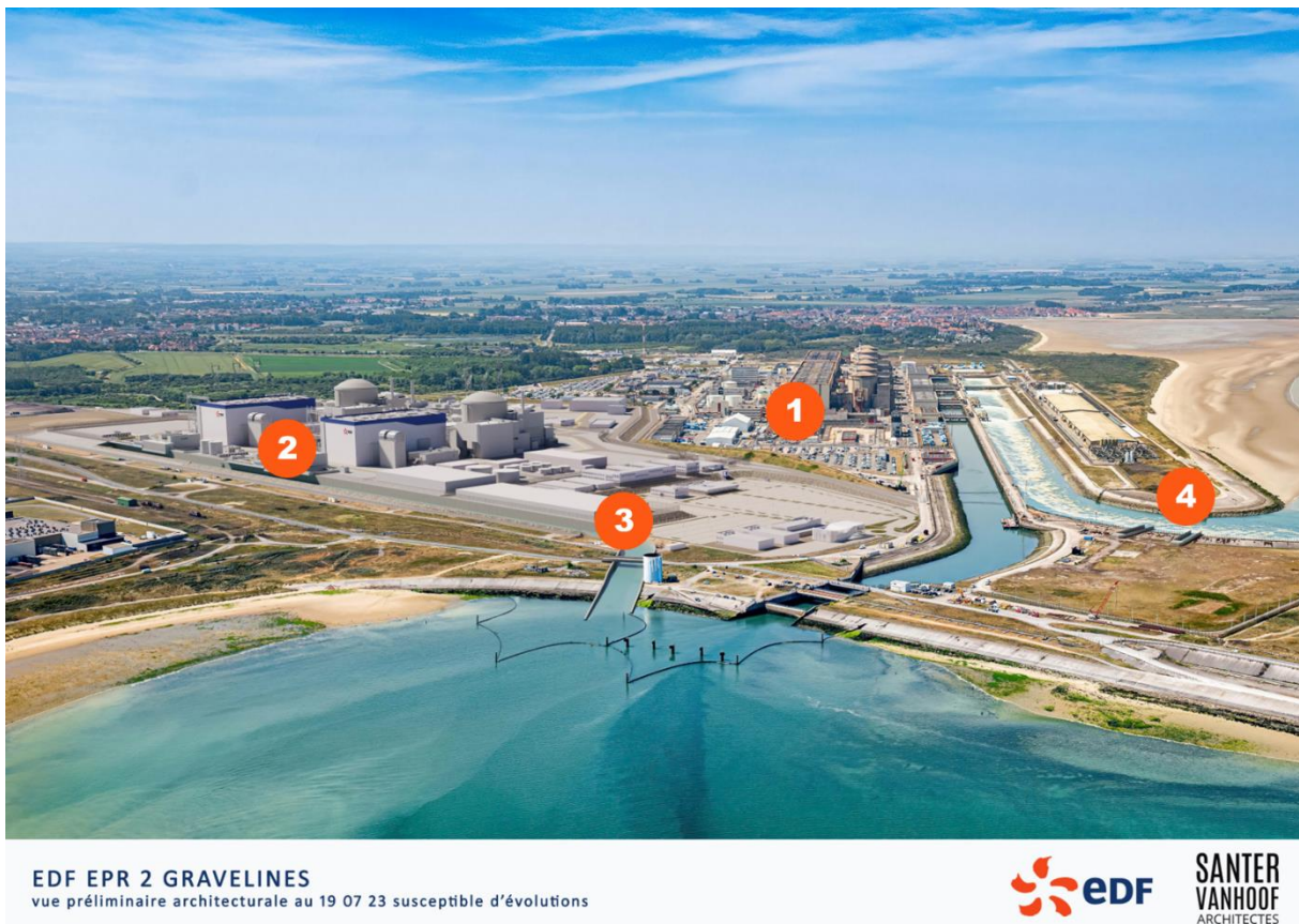
Figure 3 - Pré visualisation des ouvrages projetés pour la phase d'exploitation : sur la partie droite de la vue, les réacteurs en fonctionnement du CNPE de Gravelines (1). Sur la partie gauche de la vue, les réacteurs EPR2 en projet (2), avec le nouveau chenal d'amenée (3) et le point de rejet dans le canal de rejet (4)
