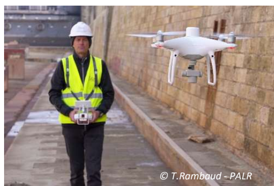
Figure 8 : Surveillance d'ouvrages par drone
