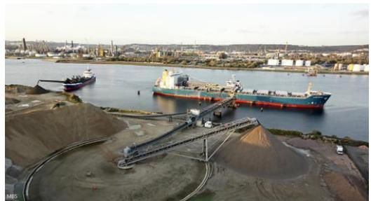
Photo n°2 : Déchargement de granulats marins sur un site récepteur - ©Eurovia
