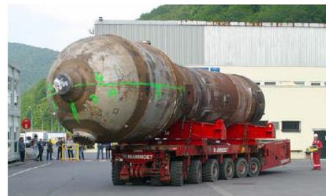
Générateur de vapeur usé en cours de manutention sur le site Et de Chooz (Ardennes)
