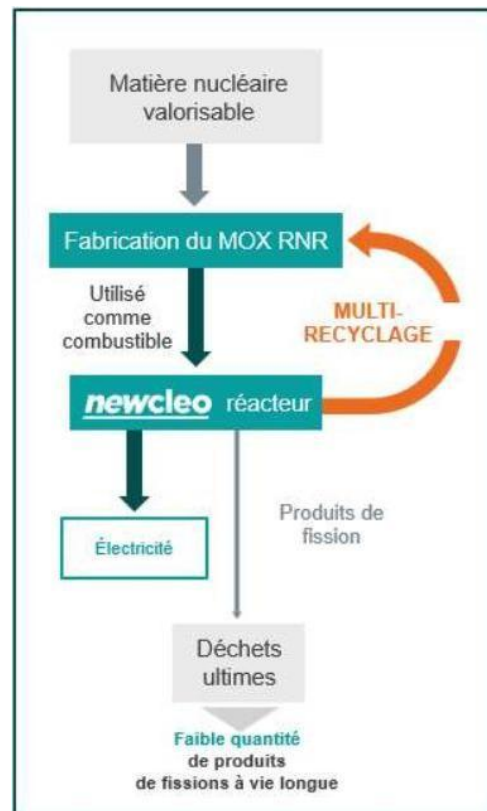
Schéma de fermeture du cycle du combustible (Source newcleo)
