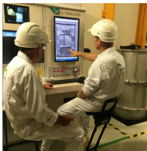
Contrôle d'un colis de déchets par radiographie X au Centre de stockage de l'Andra dans l'Aube.
